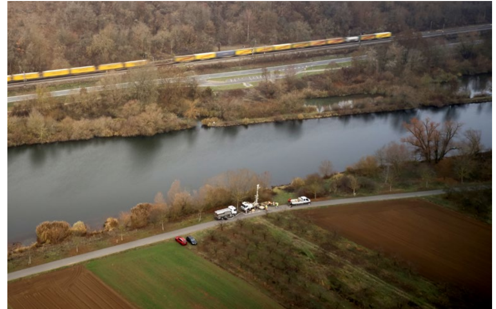
Technische Herausforderung: Querung des Mains bei Sommerhausen / Winterhausen, Querung von zwei Bundesstraßen, Eisenbahnlinie und Hanglage der Querung
